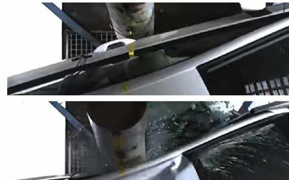
Przykład testu zderzeniowego Euro NCAP z użyciem słupa (zderzenie boczne).
